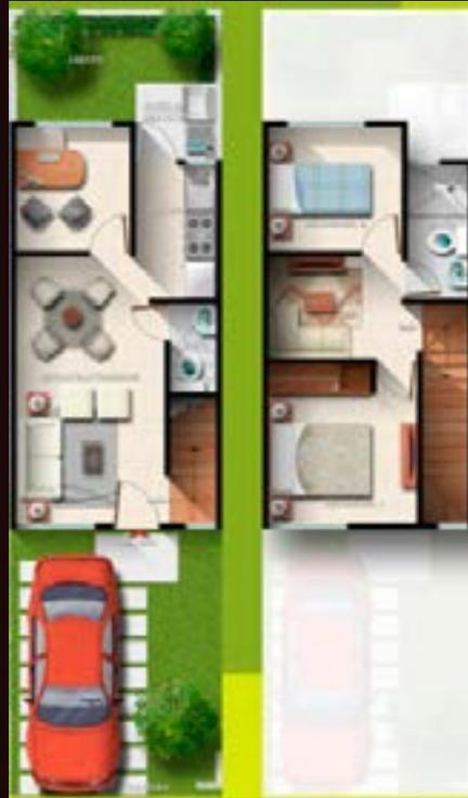
Modelo Cedrón, tiene una superficie de terreno de 60 m<sup>2</sup> con un frente de 4 mts y 15 mts de profundidad, y una superficie construida de 60.72 m<sup>2</sup> en dos niveles.
